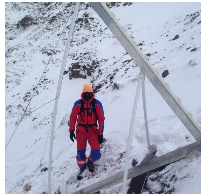
MYND 9. SM4 snjódýptarmælir. Hitanemar á 3 m langri stöng mæla hita í snjónum með 20 cm millibili. Breytingar í hita með tíma eru notaðar til þess að greina hvaða nemar eru á kafi í snjó og hvaða nemar standa upp úr og þessar upplýsingar nýttar til þess að meta snjódýpt.
